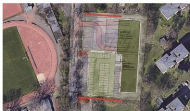
Diese Grafik skizziert die Planung für das Feuerwehr-Gerätehaus an der Backumer Straße. Die obere dunkelgrüne Fläche stellt die Fahrzeughalle dar, die untere das Hauptgebäude. Die roten Linien deuten die Lärmschutzwände an: die obere 5 Meter hoch, die untere 2 Meter. FOTO STADT HERTEN
