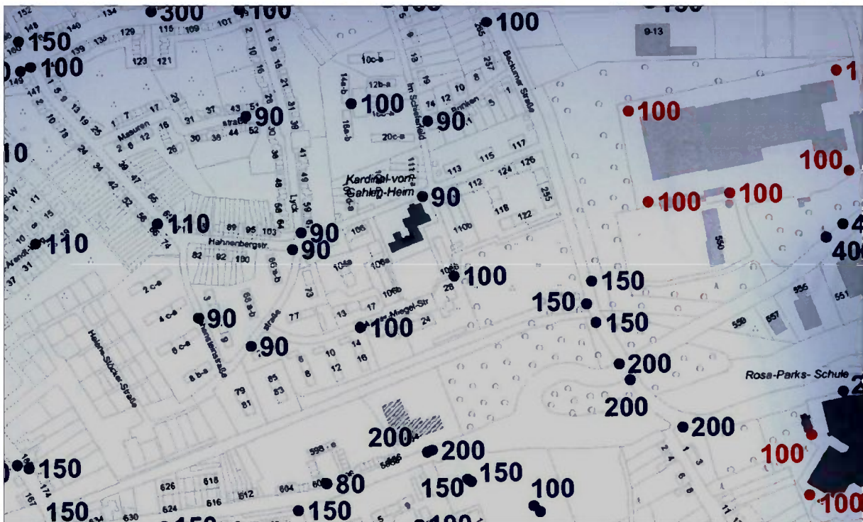
Auszug aus dem Hydrantenplan. Aus den Zahlen lässt sich abschätzen, wie viel Löschwasser entnommen werden kann.
